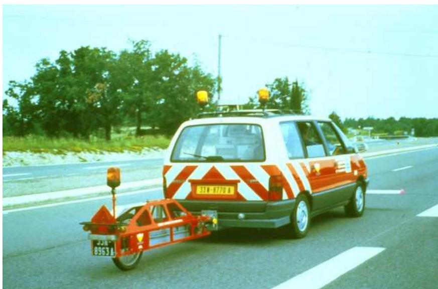
Fig. 4 : Véhicule muni à l'avant d'un Transversoprofilomètre à Ultra-Sons et à l'arrière d'un Analyseur de Profil en Long
