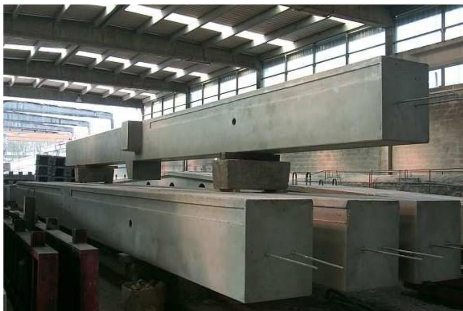
Fig. 15 : Poteaux préfabriqués
