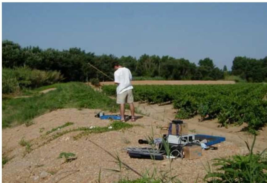
Fig. 6 : Auscultation de la digue par endoscopie
