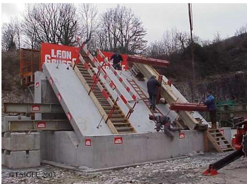
Fig.2 : Dalle de test inclinée
