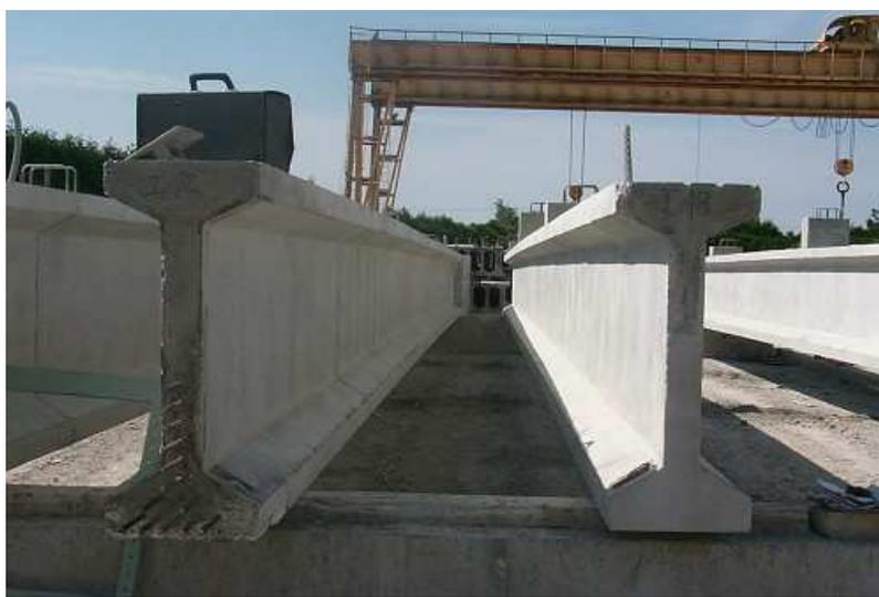
Fig. 1 : Stockage de poutres en I préfabriquées
