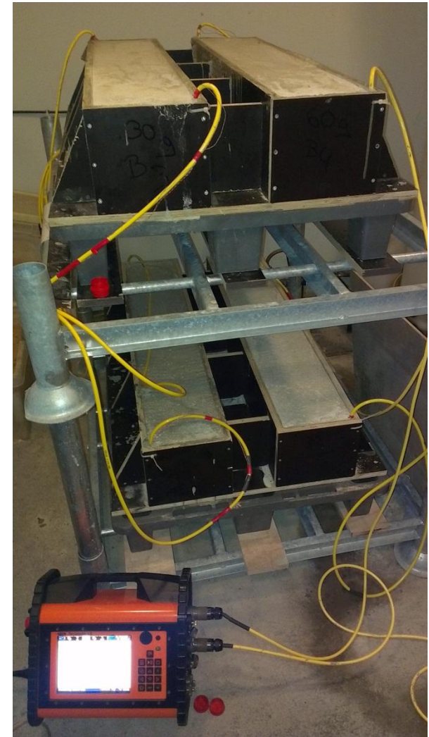
Montage expérimental pour le sondage électrique dans le béton
